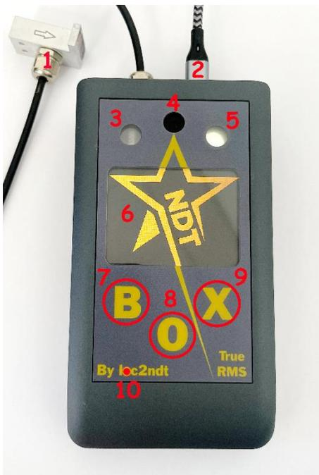
1. Sonde coudée a effet Hall pour mesure des champs tangentiels et rémanents (max 12 000 A/m) et température (-55°C à 125°C)
